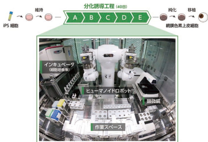
中央のヒューマノイドロボットLabDroid「まほろ」には、iPS細胞から目の網膜(RPE細胞)をつくる工程が実装されている
